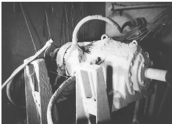
Bild 9.3 Prüfung der Staabdichtheit durch 6 Zyklen Erwärmung/Abkühlung nach UL 674 und Verfahren B nach IEC und EN 60241-1
