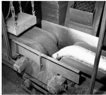
Bild 18.2 Trommelmotoren in einer Gießerei unter Bedingungen, die für einen offenen Kettentrieb nicht zulässig wären
