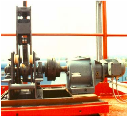
Bild 1.1.7 Antrieb von Klopfern zum Reinigen der Sprühelektroden an LURGI- Entstaubungsfiltern mit typischen Drehzahlen < 1 r/min
