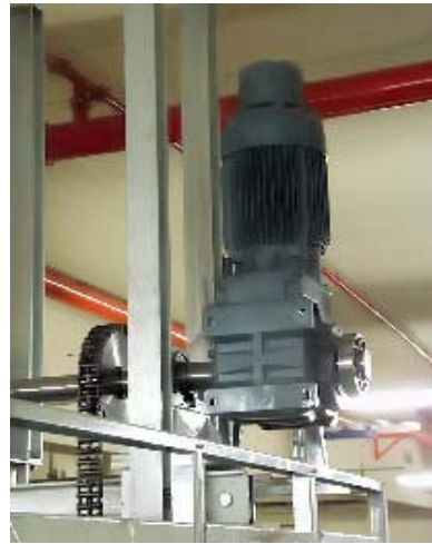
Bild 12.1.2 Anwendungsbeispiel für einen Kegelrad-Getriebemotor der Reihe BK an einem Heber
