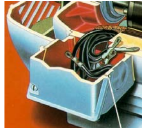
Bild 30.3.1 Typischer Motor-Anschlusskasten nach nordamerikanischer Praxis: Lose Wicklungsenden (ohne Anschlussplatte) zur »wire-to-wire«-Verbindung mit den Netzleitern
