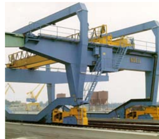
Bild 46.5 Sonder-Kurzschlussläufermotoren der Bauart DL am Fahrwerk eines Portalkrans
