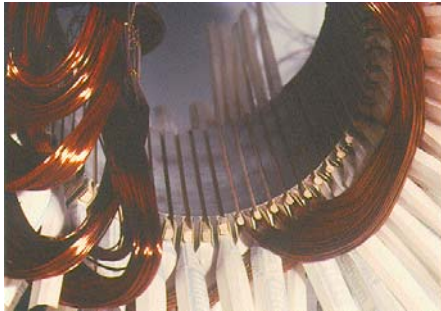
Bild 43.0.1 Manuelle Herstellung der zwei getrennten Wicklungen eines polumschaltbaren Motors
