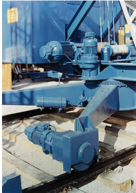
Bild 23.1 Anwendungsbeispiel für Getriebemotoren im Aussetz-Schaltbetrieb S4: Fahrwerk, Drehwerk und Hubwerk an einem Turmdrehkran
