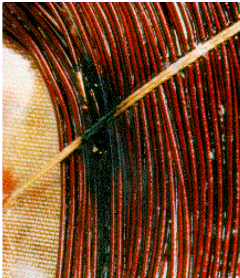
Bild 12.1.7 Charakteristischer örtlicher Spannungsdurchschlag und Windungsschluss am Wickelkopf eine Drehstrommotors als Folge von TE wegen Spannungsspitzen aus einem PWM-Umrichter
