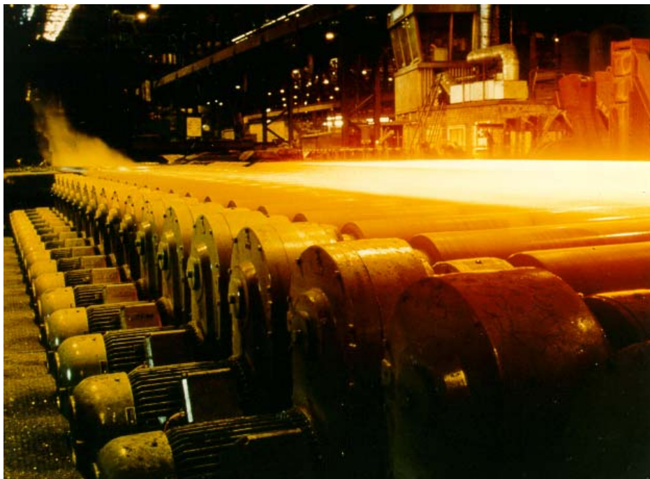
Bild 8.3.3 Arbeitsrollgang in einem Walzwerk – typische Anwendung für frequenzgeführte Reversierung
