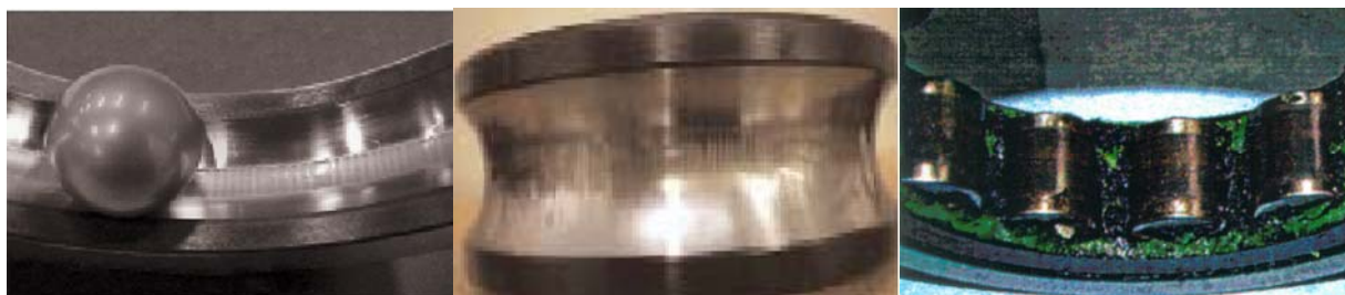
Bild 11.2 Schadensbilder an Wälzlagern Stromdurchgang wegen Oberschwingungen
