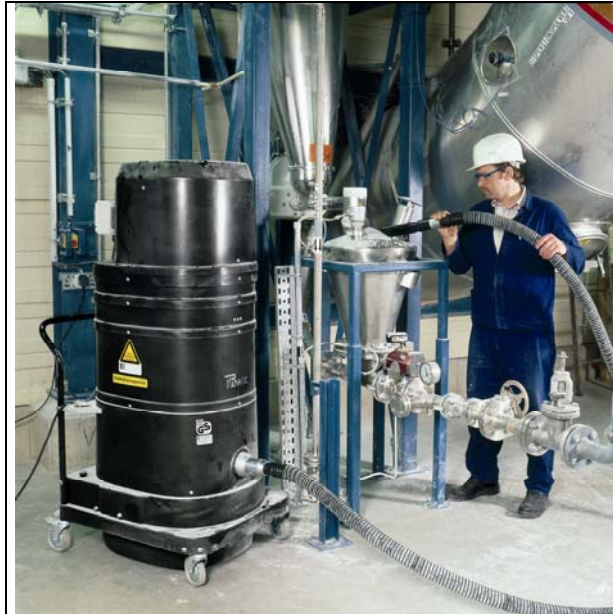
Bild 26.7 Industriestaubsauger der Staubklasse M Bauart 1 (zündquellenfrei) mit BIA- GS-Prüfbescheinigung für Zone 22
