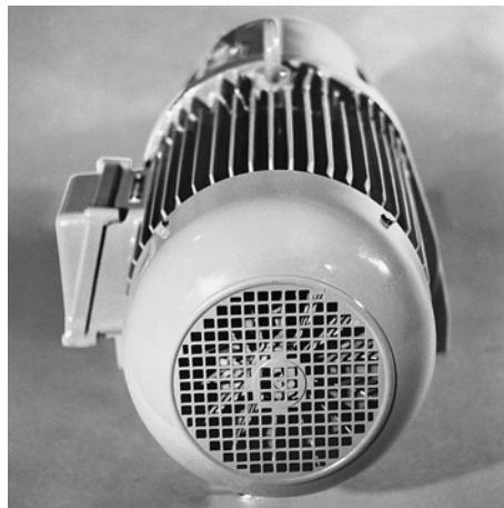
Bild 4.3.1 Lüfterhaube eines explosionsgeschützten Getriebemotors in Zündschutzart "e" für waagerechte Aufstellung: Am Eintrittsgrill genügt der Schutzgrad IP2X mit 12 mm Maschenweite – meist wird eine Maschenweite 8 mm x 8 mm ausgeführt
