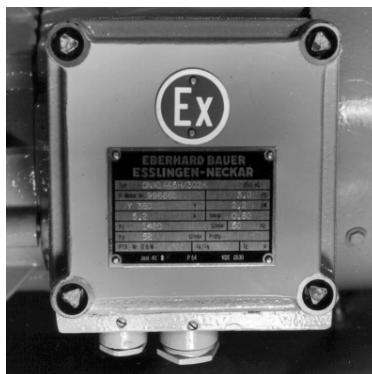
Bild 38.2 Dreikantschrauben im Schutzkragen als ein "Erkennungszeichen" für die Zündschutzart "d" nach überholter nationaler Norm
