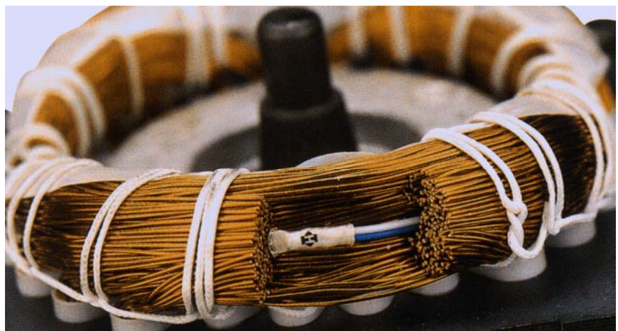
Bild 11.9.1.2 Optimale Einbettung eines Thermistors nach Herstellerangaben (THERMIK)
