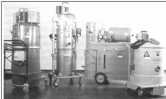
Bild 26.7 Industrie- staubsauger der Bauart 1 (zündquellenfrei) nach BIA- Prüfanforderung für frühere Zone 11 (jetzt Zone 22)
