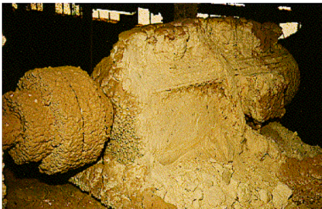
Bild 26.5 "Übermäßige Staubauflage" bei einem Getriebemotor in einer Mälzerei
