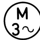
BAUER-Getriebemotoren für Drehstromanschluß werden mit speziell angepaßten Asynchronmotoren geliefert. Die Auslegung ermöglicht größte Betriebssicherheit bei hohem Anzugsmoment und geringem Einschaltstrom.
