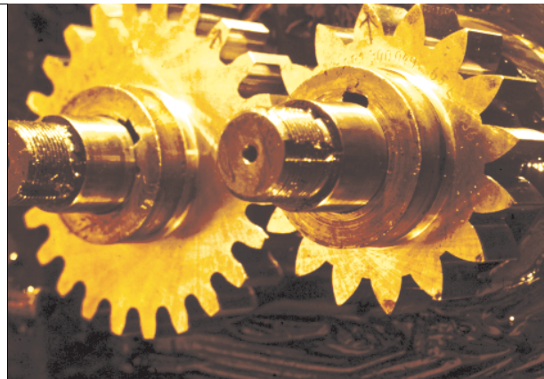
Bild 10.3.4 Prüfräder im FZG-Prüfstand zur Prüfung der Hochdruckeigenschaften von Schmierstoffen unter extremen Bedingungen wegen ungünstiger Zahnform
