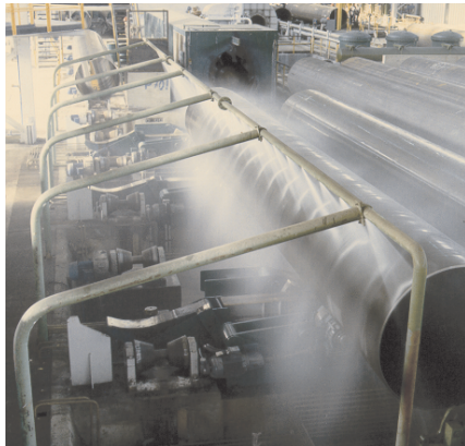
Bild 4.4.4 Entzunderung von Großrohren durch Strahlwasser mit hohem Druck Rollgangmotoren und Hilfsantriebe in Schutzart IP66
