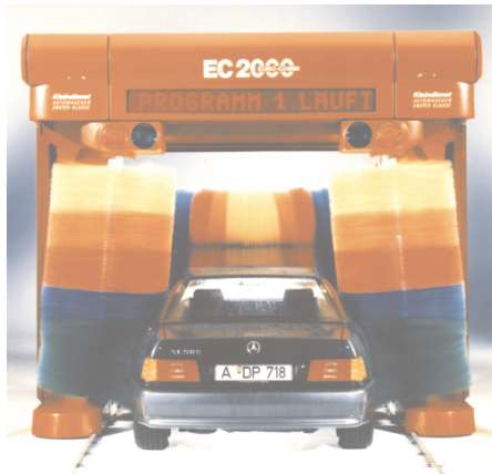
Bild 4.4.5 Für elektrische Betriebsmittel im direkten Wirkungsbereich des Wassers einer Autowaschanlage werden besondere Schutzmaßnahmen empfohlen.
