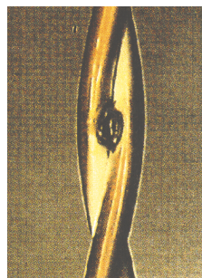
Bild 5.2.3.3.1 Lokaler Spannungsdurchschlag an einem Twist Quelle: Drahthersteller ESSEX
