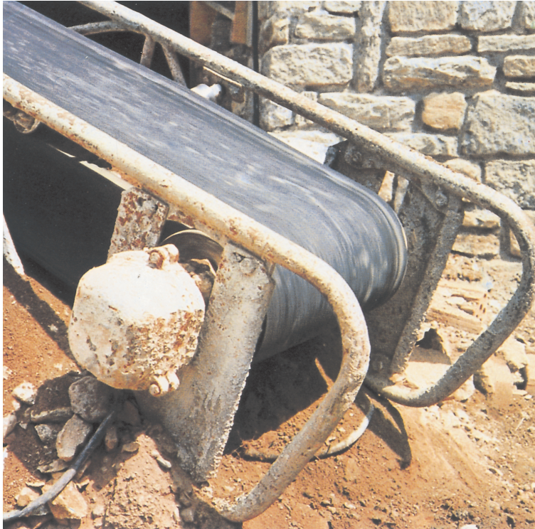
Bild 4.7.3 Trommelmotor an einem tragbaren Gurtförderer im harten Baustelleneinsatz
