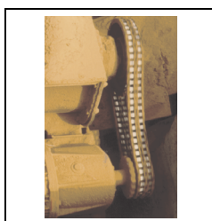
Bild 8.6.3.3 Häufig anzutreffende, ungünstige Anordnung eines Kettenritzens am Ende der Arbeitswelle
