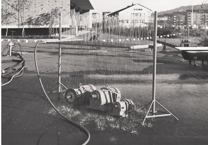
Bild 4.7.1.2 Langzeitberegnung von Getriebemotoren zur Prüfung auf Aufstellbarkeit im Freien
