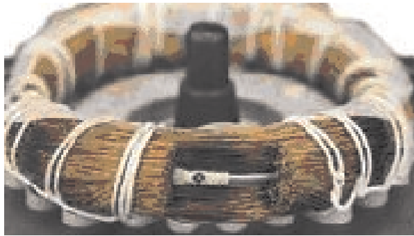
Bild 6.2.2.3.1 Arbeitsschritte beim Einbau der Thermistoren in den Wickelkopf nach Herstellerangaben [2.20]
